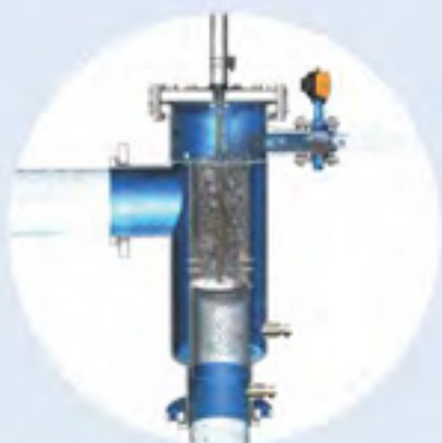
Фильтрация. 2-я стадия очистки. Очищающий диск опускается внутрь сетки дважды, создавая эффект Бернулли, тем самым отрывая от сетки остатки загрязнений
