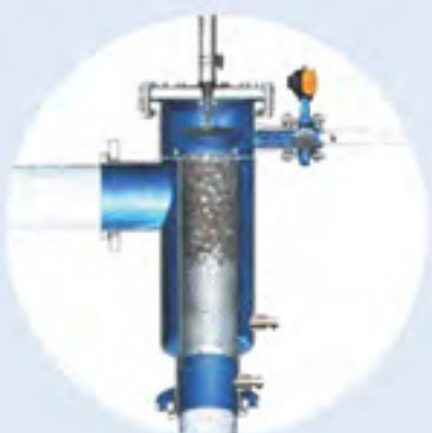
Фильтрация. 1-я стадия очистки. Срабатывает таймер или реле давления, открывается сбросной клапан, крупные частицы вымываются
