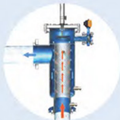
Работа в режиме фильтрации Диск находится вне корзины фильтра.
